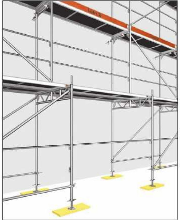
Att. 105: Portāla rāmju uzstādīšana
